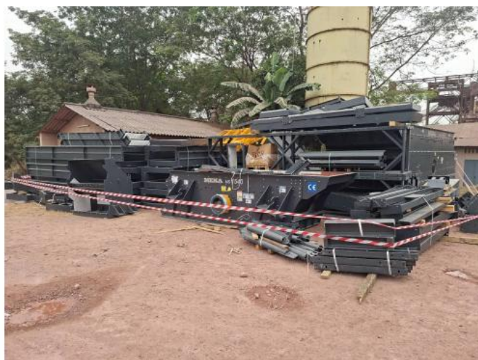
Photos du nouveau concasseur tertiaire et de la nouvelle unité de criblage, en cours d'installation
