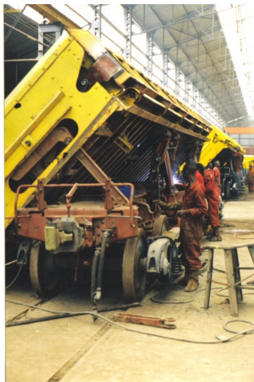
Fig. 5 – fabrication wagons basculeurs (Gécamines)
