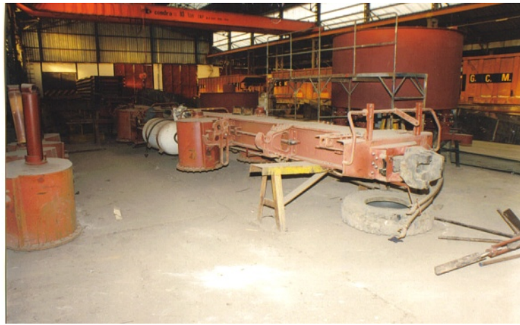
Fig. 13 – Fabrication de châssis de wagons basculeurs.
