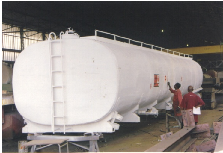
Fig. 12 – fabrication d'une citerne à carburant
