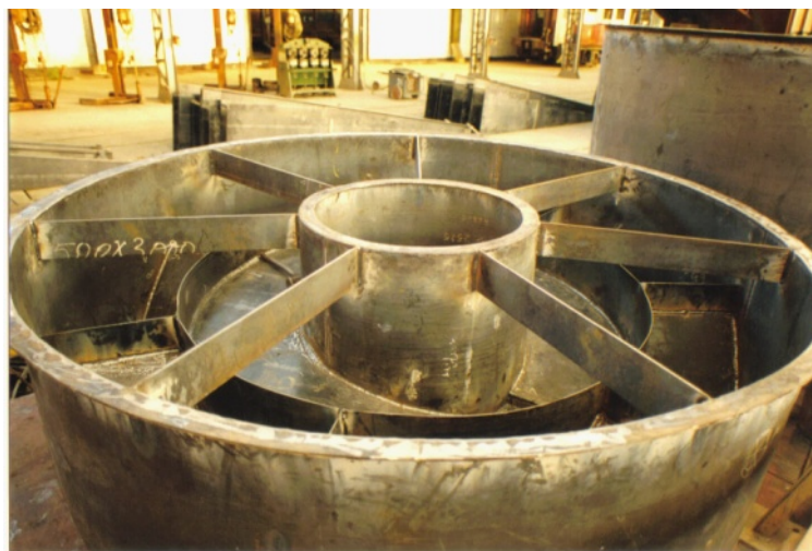
Fig. 7 – fabrication d'un distributeur rotatif à 7 boîtes
