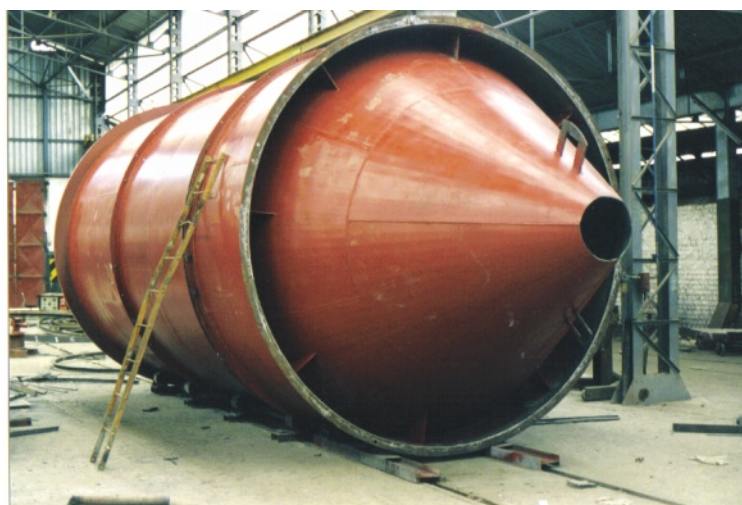
Fig. 9 – Fabrication d'un Pachuca d'une capacité de 82 m 2
